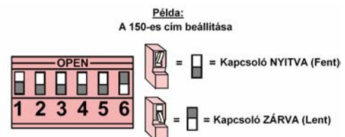
43. ábra: A DX3010 DIP kapcsolóinak konfigurálása
